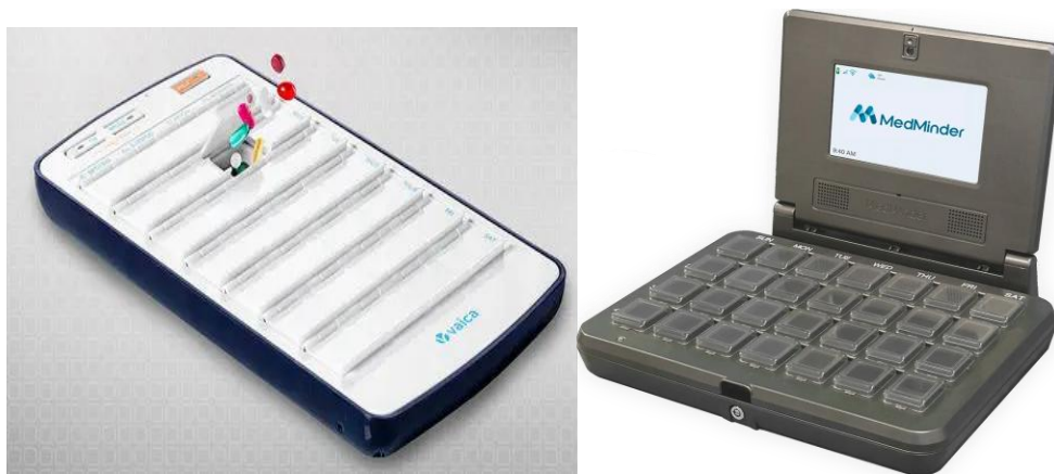
Figura 9-10: Esempio di Blister elettronico con allarmi e wireless SimpleMed+
